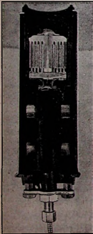
Fig. 2. Doorsnede door den voor variëring der bandbreedte ingerichten 1sten m.f. transformator. Ongeveer ware grootte. De onderste spoel kan op en neerbewogen worden, waardoor de koppeling tusschen de twee kringen (en daardoor de bandbreedte) wordt geregeld. Geheel onderaan ziet men de trek-inrichting van het Bowdenkabeltje, waardoor de beweging van den bedieningsknop wordt overgebracht op het onderste spoeltje. In de figuur is de afstand tusschen de spoeltjes maximaal, zoodat dit de meest selectieve stand is. Bovenaan ziet men in doorsnede een trimmer-condensator met luchtisolatie. Wanneer met een schroevendraaier de kop in de van schroefdraad voorziene bakelieten buis wordt gedraaid, schuiven de platen meer of minder in elkaar.
